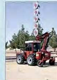
Giro hidráulico del módulo de corte (varía la incidencia del corte)
